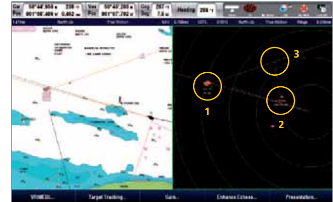
Der Alarm wurde bestätigt, und der nächste Punkt der Annäherung (CPA) an das Ziel (1) (jetzt mit einem roten Dreieck versehen) wird auf dem Bildschirm mit 0,376 mm (3) angezeigt. Die Zeit bis zum Punkt der nächsten Annäherung (TCPA) beträgt 4 Min. und 20 Sek. (2).
