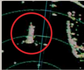
"Verschmelzung" von Zielen beim 25 kW 8,5' Radarsystem.
