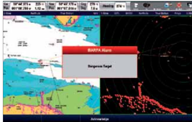
Das verfolgte Ziel fährt nun in die vorab eingestellte Gefahrenzone und löst einen Gefahrenalarm aus (siehe Bildschirm). Außerdem wird ein Audio-Alarm ausgelöst.
