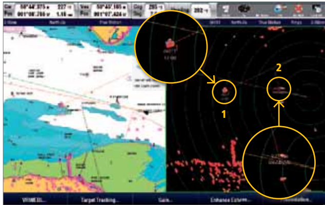
Ziel 1 (roter Kreis) wurde durch MARPA erkannt und wird nun durch das Radar verfolgt. Geschwindigkeit und Peilung des Ziels werden angezeigt. Der Zielkurs wird als dünne rote Linie bei 65° angezeigt.
