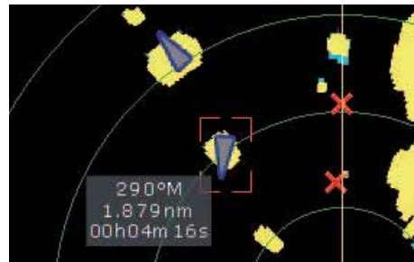
Overlay von AIS-Zielen mit Radar-Kontakten auf Raymarine-Multifunktionsdisplays
