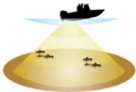
Sendekegel rotiert nach vorne und nach hinten
