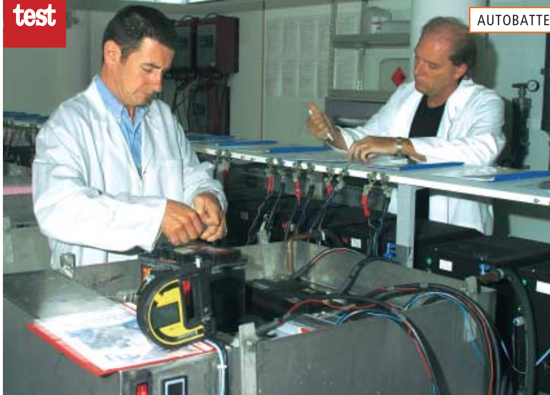
Unten: Programmierung der Lade- und Entladevorgänge.
